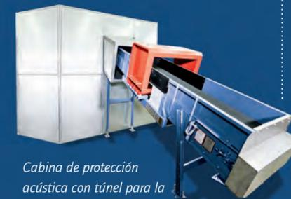
Cabina de protección acústica con túnel para la cinta de transporte, cinta de transporte y detector de metales
