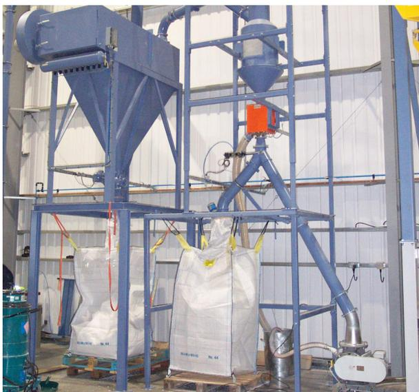
Zyklonabscheider mit Feingutscheider HS 300 (Absackausführung)
