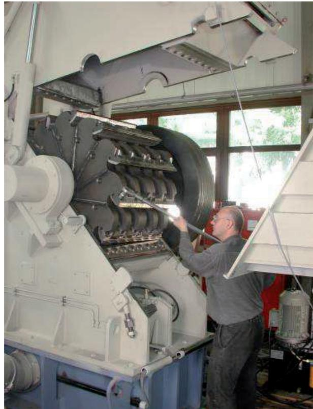
*Rotormesserbefestigung mit Drehmomentschlüssel an einer HERBOLD-Rohrschneidmühle, Typ SMR 80/120*
