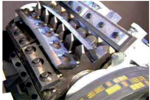
Rotormesser einer HERBOLD-Profileschneidmühle, Baureihe SMP
