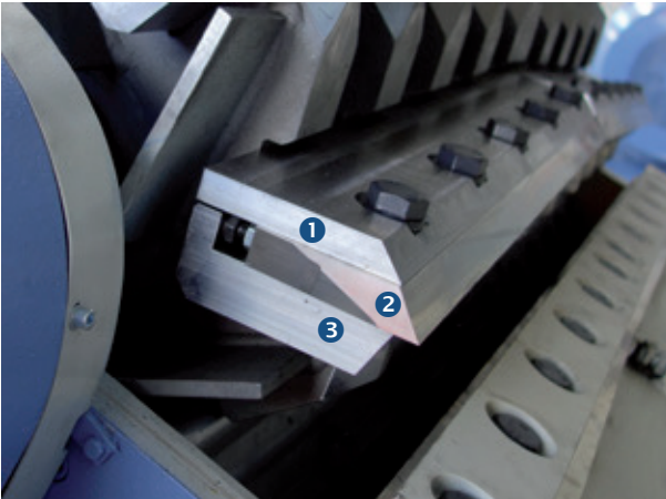
Abb. 3: ① Messerdruckleiste ② Rotormesser ③ Auswechselbares Verschleißteil.
