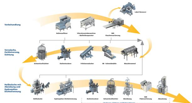
Fig. 4 : Flow-sheet pour une installation de lavage pour films agricoles
